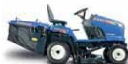
Der ultimative Diesel-Mähtraktor mit 16 PS Max.-Leistung, 102 cm Schnittbreite und Anbauoptionen zum Ganzjahreseinsatz. Prädestiniert für Rasenflächen ab 2.500 m<sup>2</sup>.
